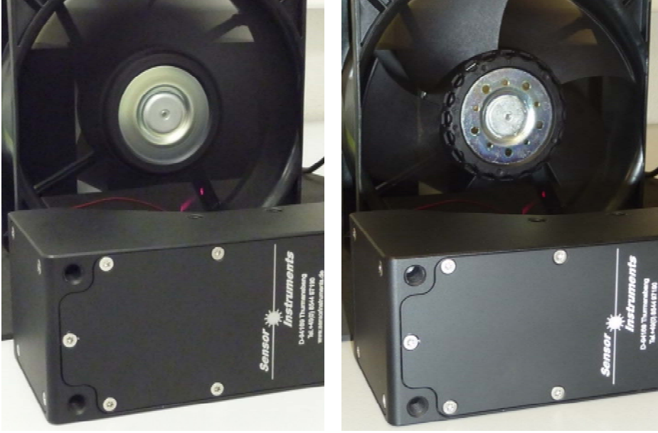
Rotor kanatlarının RED-50-L lazer yansıyan ışık kenar detektörü ile algılanması ve sayılması
