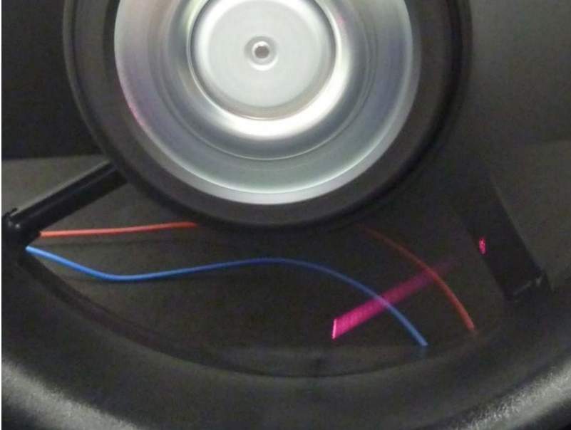
RED-50-L sensörünün lazer demeti fan tipinin rotor kanatlarına yönlendirilir
